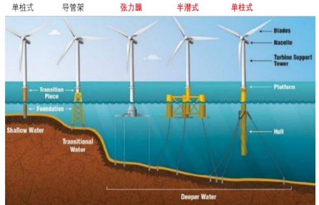
图表22 适应不同水深的海上风电基础结构示意图
