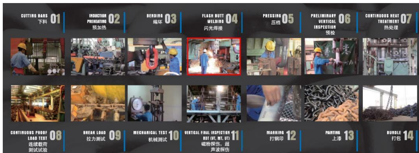
图表36 典型的系泊链生产流程
