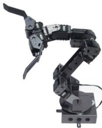
图2：使用碳纤维复合材料制造的机械臂
