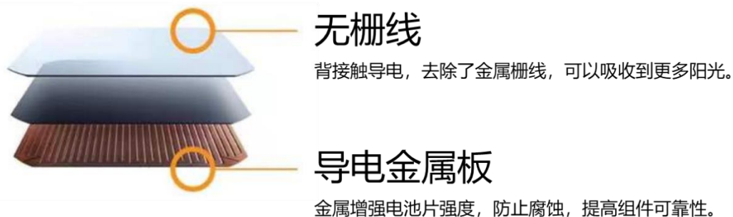
图表32: Maxeon 背面使用了导电金属板
