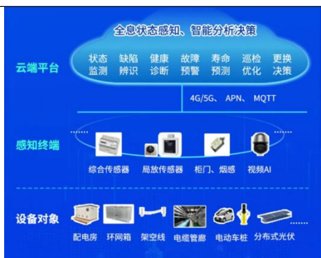
图51：配电网健康诊断与智能运维系统示意图
