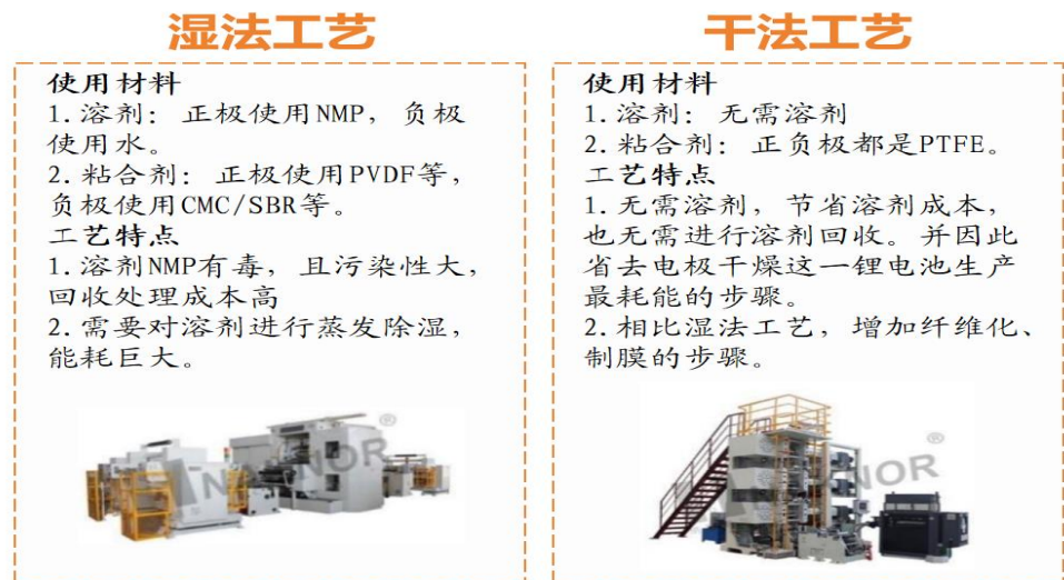
图 11：湿法电极与干法电极的比较
