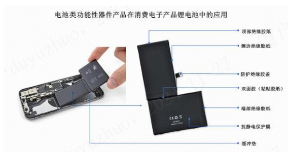
图 10：功能性器件在消费电子电池中的应用
