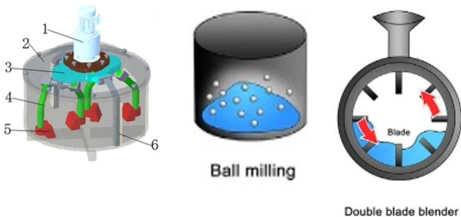
图：双行星搅拌机（左）、球磨机（中）、双刀锋混合设备（右）示意
