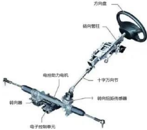
图 25: 电子助力转向 (EPS) 结构示意图
