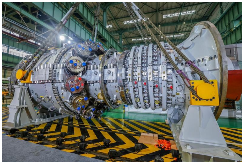
图45: 2024 年 2 月中国联合重燃 F 级 300MW 重型燃气轮机整机下线成功
