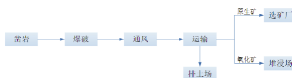
图12：地下开采工艺流程图
