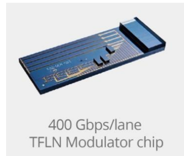
图：光库科技400Gbps/lane 薄膜铌酸锂调制器芯片
