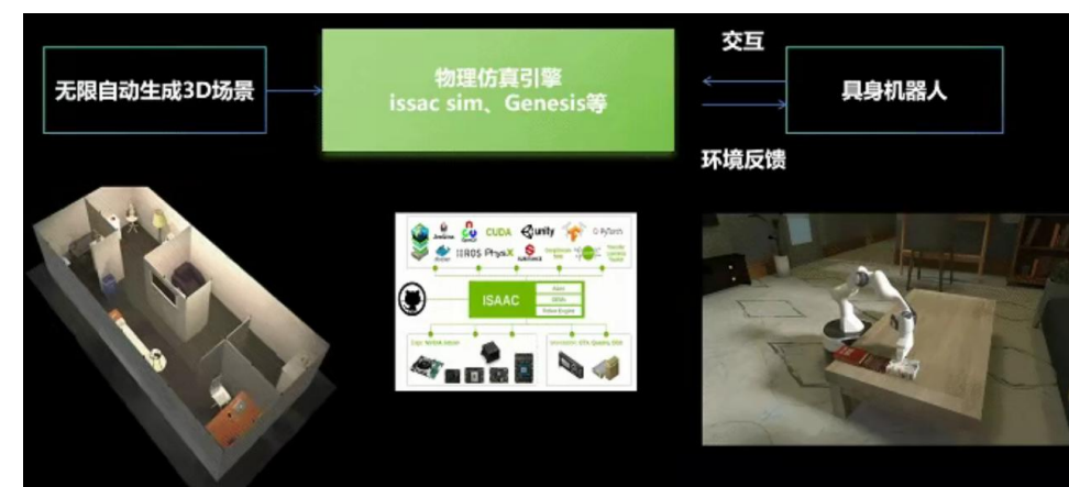
图：“3D场景合成+仿真模拟+现实交互” sim2real技术框架
