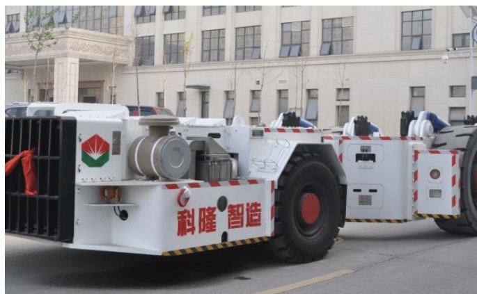
图24：框架式支架搬运车可以实现重型设备的快速搬运
