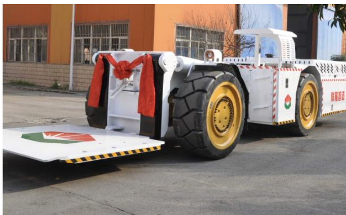
图23：铲板式支架搬运车在井下可以做到一车多用
