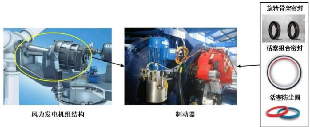
图18：公司产品主要用于风电机组制动器的内部密封
