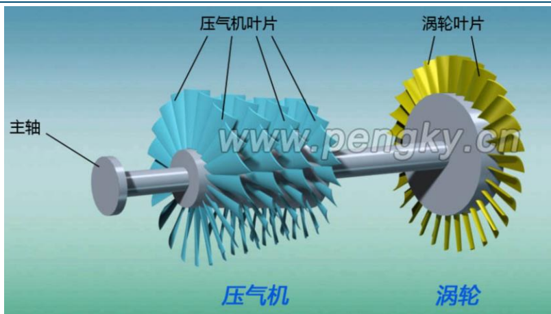
图表35：燃气轮机叶片分为压气机叶片和涡轮叶片
