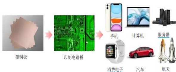
图 3：覆铜板 CCL-印制电路板 PCB-终端应用图示
