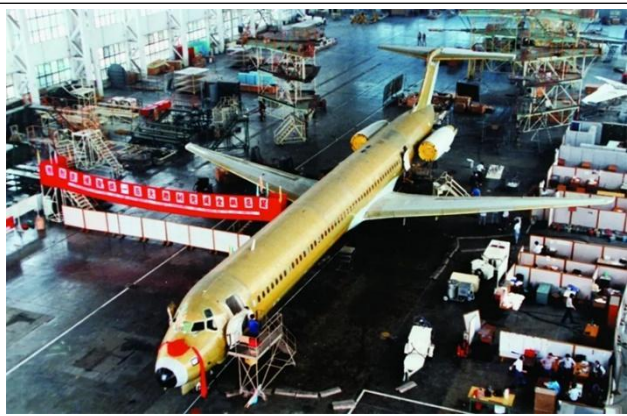
图 7：上海飞机制造厂 MD-82 飞机总装现场
