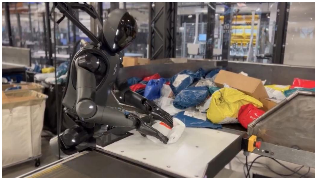
图 5：Figure 发布视频展示灵巧手分拣包裹的能力
