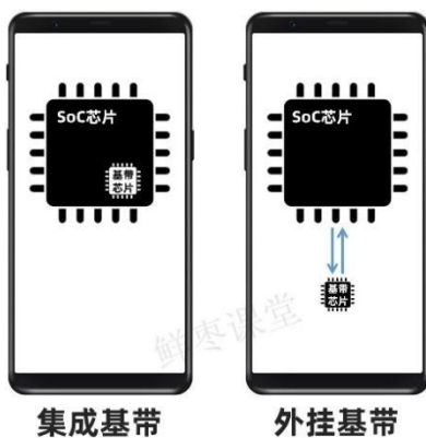
图3：集成基带 VS 外挂基带
