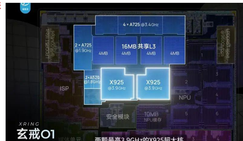
图：玄戒O1 CPU架构
