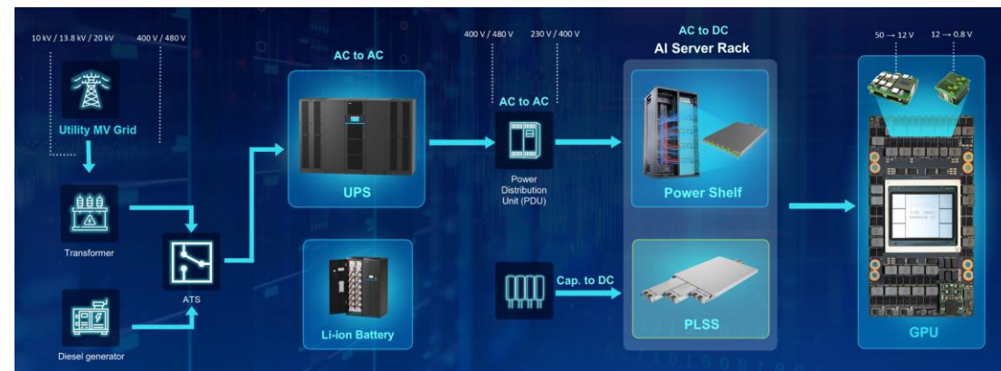
图：AIDC电气设备架构
