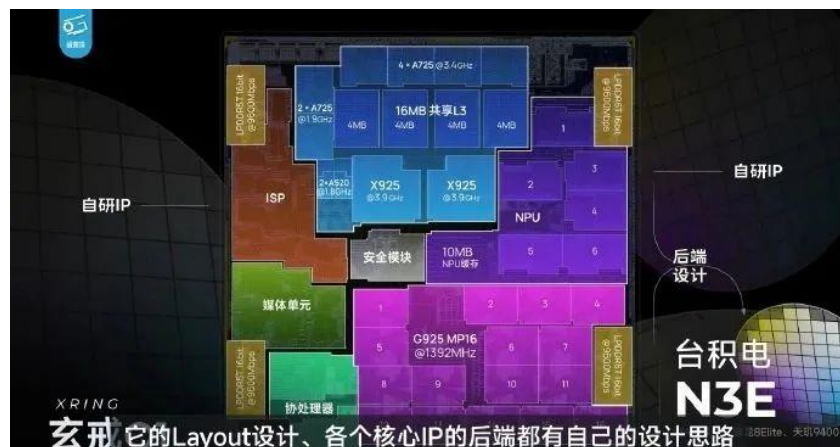
图：玄戒O1 Layout设计图
