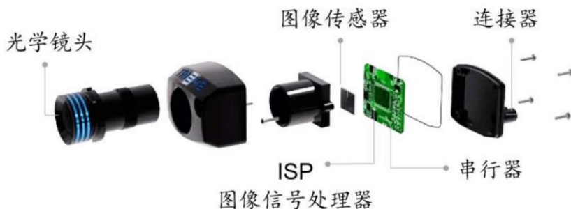
图表11：车载摄像头基本结构构成
