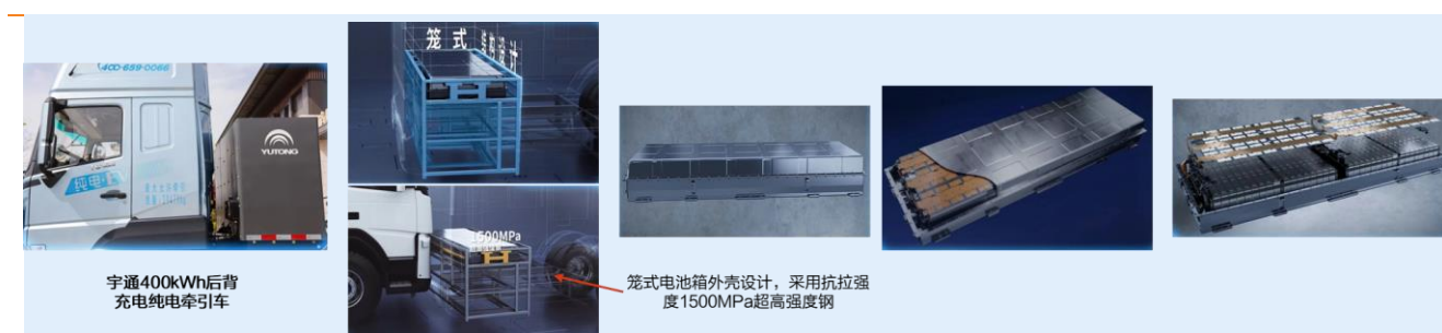
图 20：宇通重卡采用 1500MPa 高强度钢笼式结构
