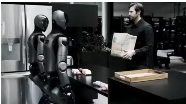
图59: Figure 机器人采用视觉-语言-动作模型 (VLA)
