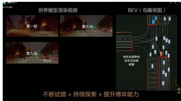
图4：使用世界模型进行仿真训练可以弥补真实数据稀缺性 理想汽车采用世界模型渲染视频来对自动驾驶进行 强化学习训练提升博弈能力
