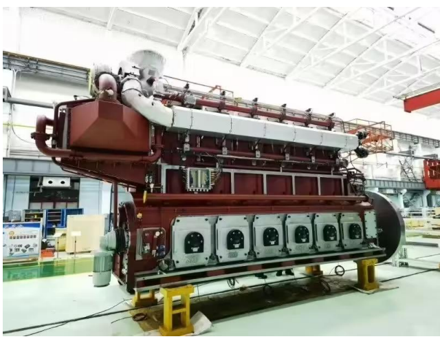
图52: 陕柴重工自主研发的 SXD6L40/52G 中速大功率燃气发动机填补了国内中速大功率天然气发动机空白
