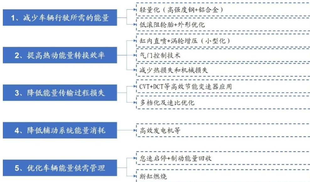
图17：汽车轻量化（高强度钢+铝合金）是降低车辆行驶所需能量的重要途径
