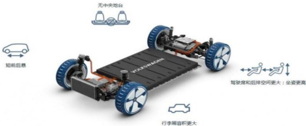
图 110: MEB 平台灵活架构
