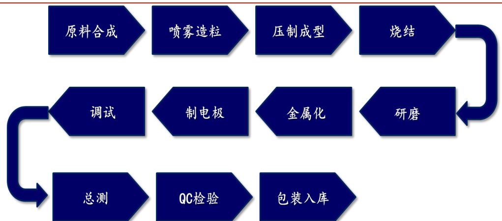
图表16: 陶瓷介质滤波器主要生产流程
