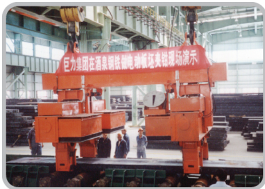
酒泉钢铁公司电动板夹钳吊装
