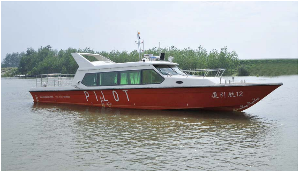
图 6-5：特种艇—引航艇 (注：该型引航艇航速可达 30 节左右，为深圳港、上海港、厦门港等港口引航站采购)
