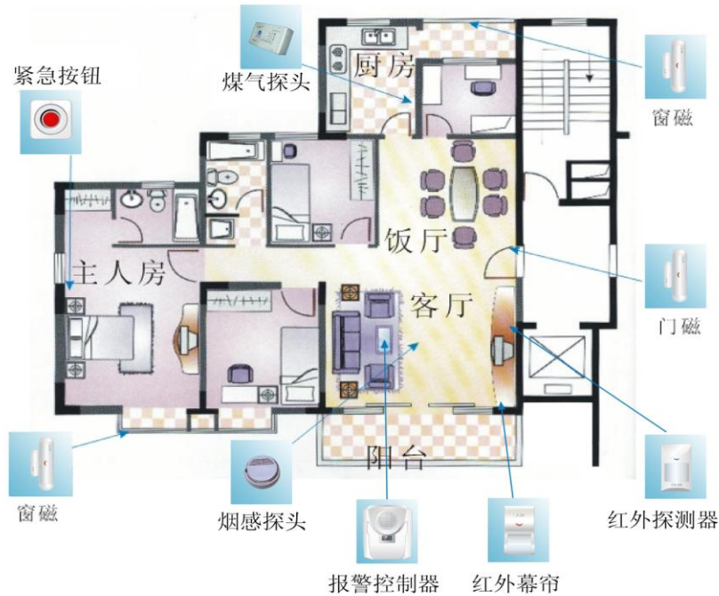
公司住户室内报警系统配置示意图
