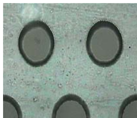
HDI钻盲孔平面图
