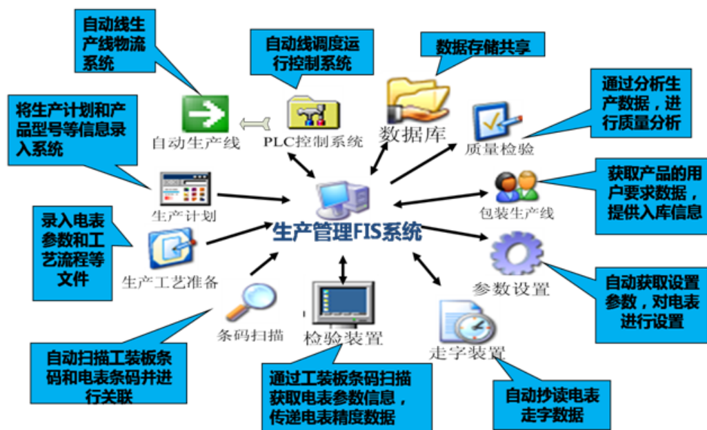
图 6-6 公司全自动化电能表生产线系统架构组成
