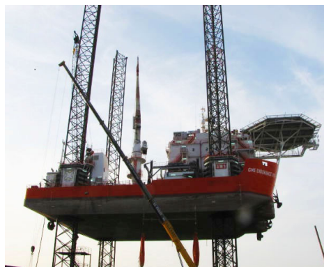
船 型：海洋工程辅助平台 主尺度：61m × 31m × 6m 入 级：美国船级社
