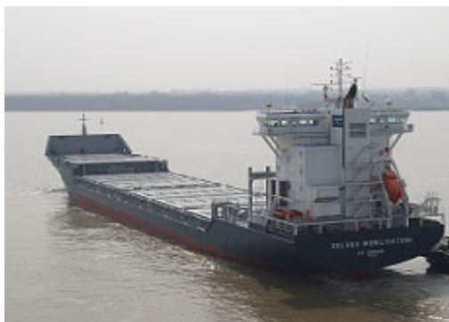
船 型: 900 箱集装箱船 主尺寸: 154.85m × 21.5m × 9.3m 载重吨: 10,600 载重吨 入 级: 法国船级社
