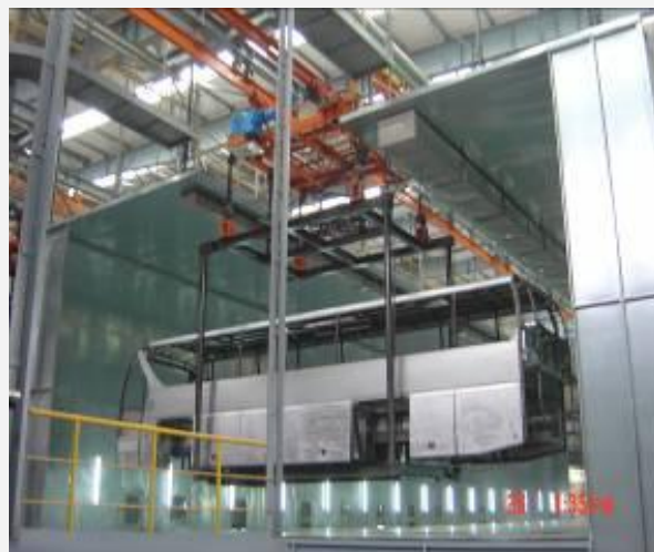
厦门金龙旅行车涂装（车身整体前处理电泳）线
