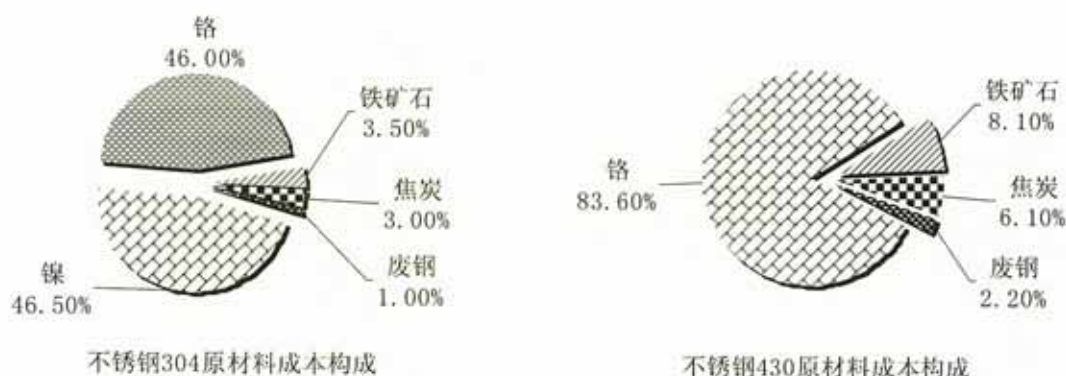
图5 不锈钢304以及不锈钢430原材料成本构成
