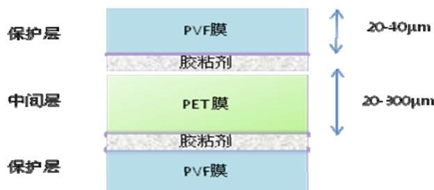
随着光伏行业的技术进步及原材料成本持续下降的要求，多种结构的新材料背板逐渐衍生出来：
