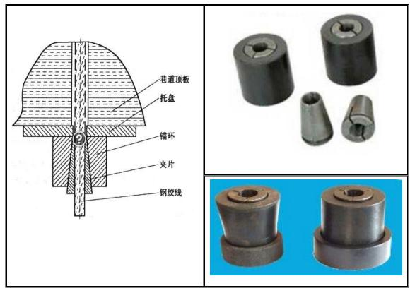
如上图所示,锚索锚具主要由托盘、锚环和夹片组成,锚环和托盘对应位置 开有通孔,锚环的通孔为内大外小的锥孔,夹片为三片式,直开缝,斜向细齿, 在楔形效应作用下,钢绞线越拉越紧,从而起到锚固的作用。
