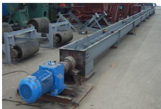
螺旋输送机通过螺旋叶片推进物料，用于水平输送，输送过程中还有搅拌物料的作用。
