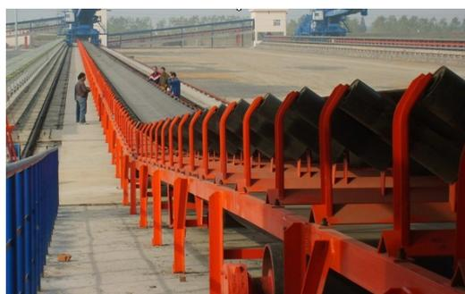
带式输送机是以输送带为牵引件和载体，用于散粒物料的水平输送，由单机或多机组合成运输系统来输送物料。服务领域主要在建材、化工、电力、港口、矿山、煤炭等行业。
