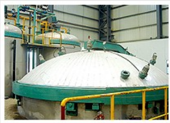
Φ5.4m真空压力浸漆（VPI）
