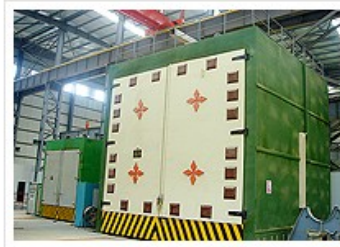
6.5×5.5×8m，承重100T大型烘房
