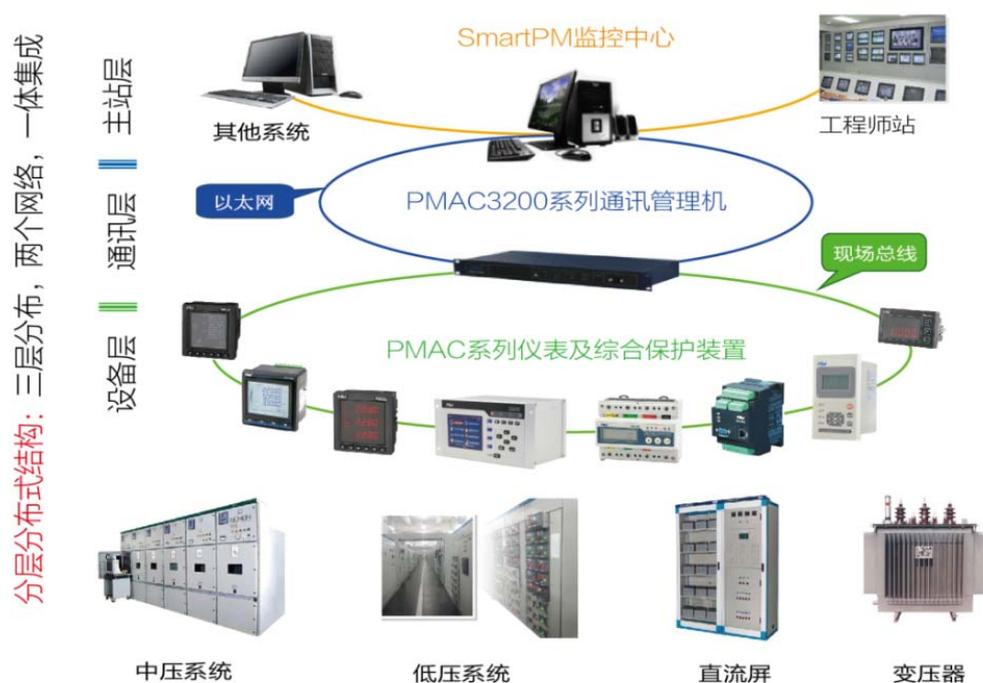
由公司自主研发、生产的系统管理软件、智能电力仪表、通讯管理机是系统价值的主要构成部分，亦是整个用电与能源监管系统的核心。
