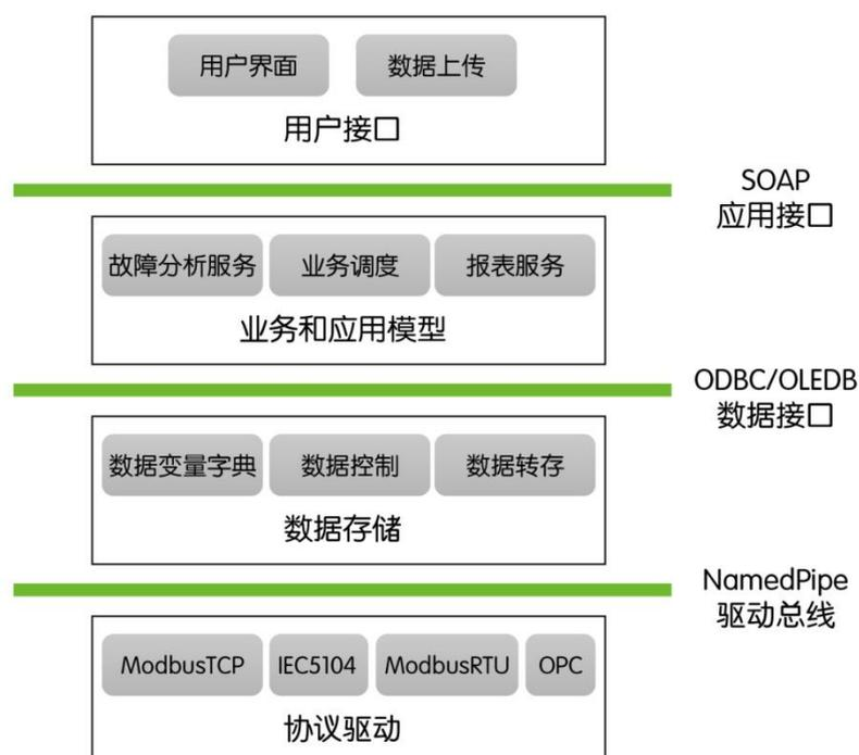
SCADA 系统平台的核心技术点在于组态技术的实现、动态脚本的解析和协议驱动引擎的设计。
