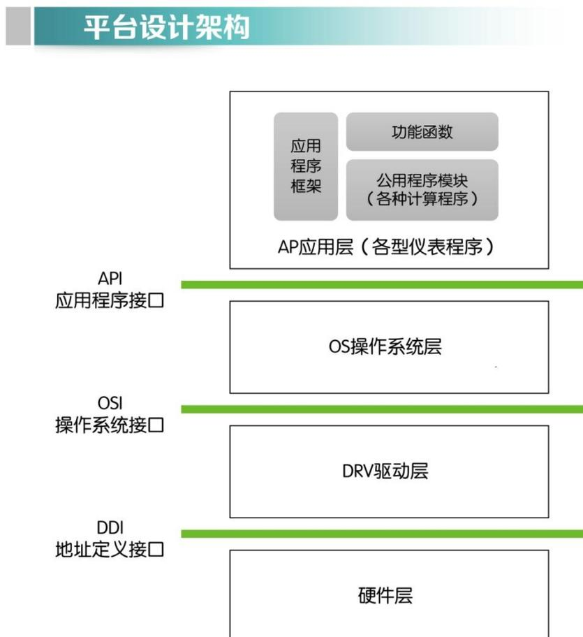
硬件层实现物理元件和逻辑驱动之间映射，由 A/D、IO、EEROM、LCD、LED、RS232、RS485、CPU、RAM 等组成，采用映射空间的形式实现同一种硬件应用到不同的平台上。
