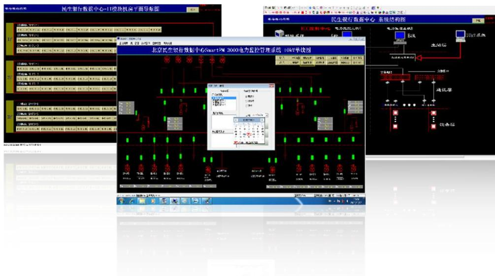
公司自主研发的中低压配电监控系统在武汉国际博览中心、上海太平金融大厦等大型项目中已成功应用，技术水平、稳定性处于行业领先地位。
