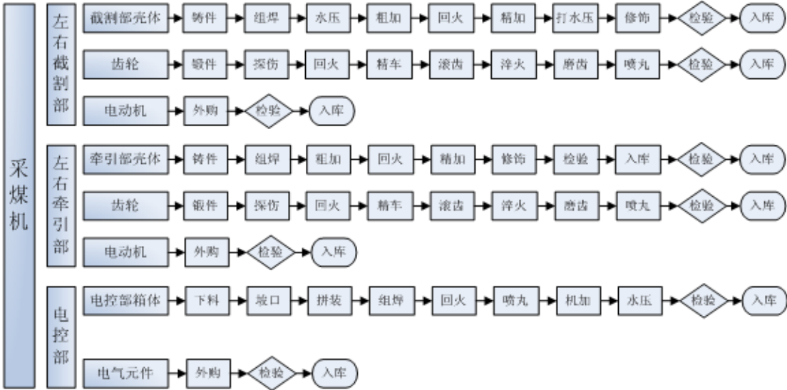
② 掘进机主要零配件生产工艺流程图：
