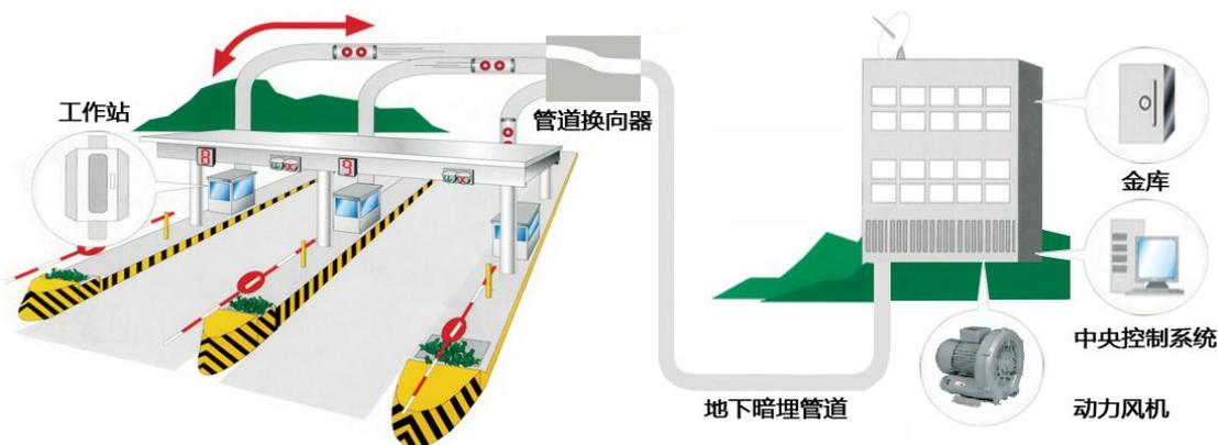
图：高速公路现金票据气动传输系统示意图
