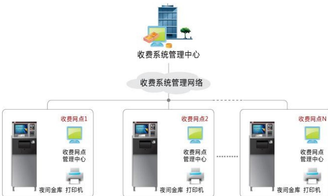
图：现金自助缴存系统构成示意图
