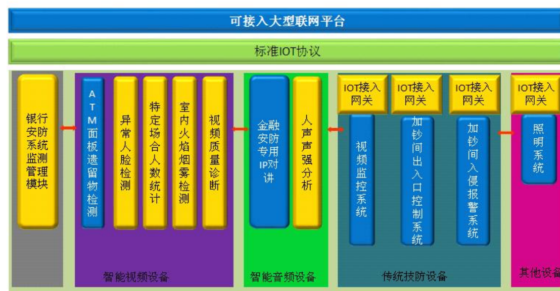
技改后银行自助设备智能安防系统示意图
