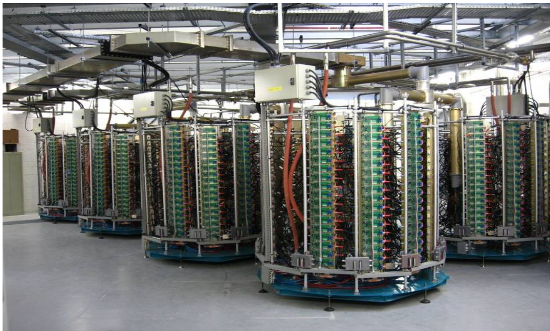
352MHz/180kW 固态功率源（公司产品为其关键部件功率放大器和功分功合
