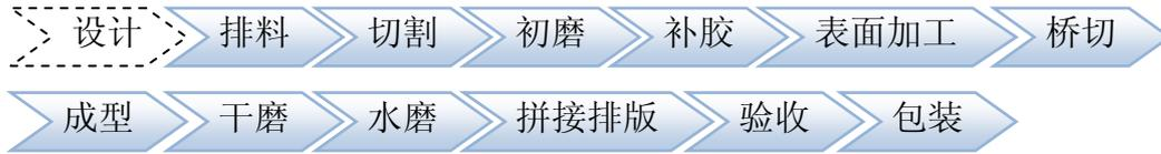
其中表面加工和成型为核心工艺。表面加工依据客户要求有磨光、亚光、火烧、自然面、龙眼面、荔枝面、皮革面、仿古面、酸洗加工等工艺；成型工艺是满足客户个性化设计的关键工艺，需要设备和熟练工人的系统配合。
