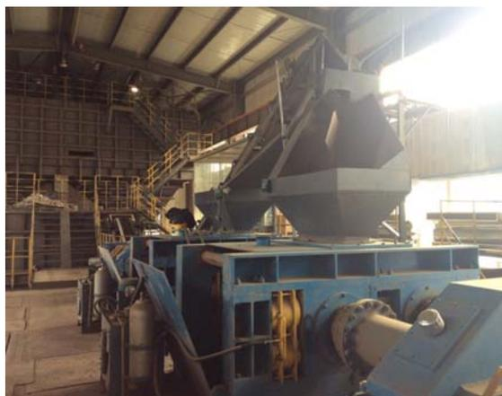
公司为吉林成大有限公司设计、制造的 40 万吨/年油母页岩小颗粒成球项目。该技术成功应用于小颗粒油母页岩干馏系统，不仅将小颗粒油母页岩再次利用，而且解决了由于小颗粒油母页岩的堆积而造成的环境污染及占地问题，为油母页岩小颗粒成球技术开辟了一条新的途径。
