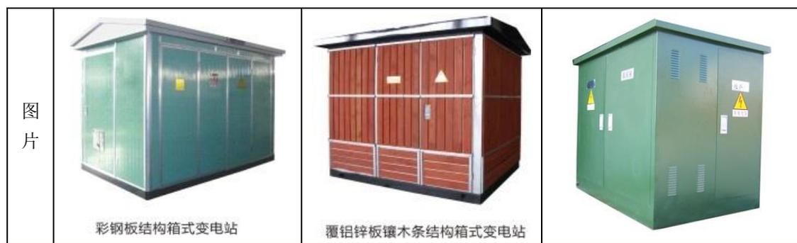
该产品由高压开关设备、电力变压器、低压开关设备、电能计量设备、无功补偿设备、辅助设备和联接件等元件组成的成套配电设备，电力变压器是其中最核心的装置。该类产品的优点是机电一体化、全封闭运行、移动方便，特别适合油田、工矿企业及临时施工场所；缺点是产品单位成本较高。公司的智能型箱式变电站以自产的三维卷铁心式变压器为核心组装而成。
