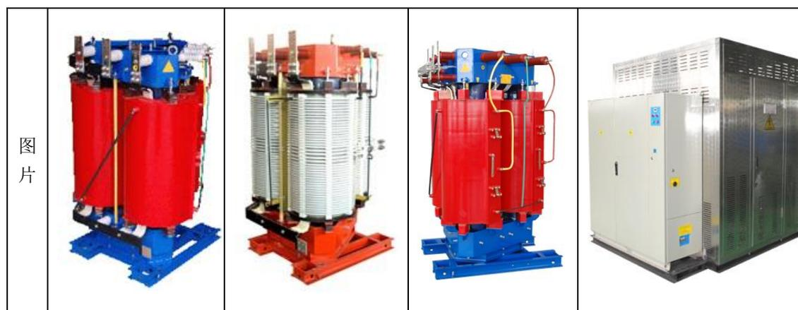
该产品将三维立体卷铁心和绕组不浸渍在绝缘液体中，而是依靠空气对流进行冷却，相对于液浸式变压器，干式变压器因没有液体，也就没有火灾、爆炸、污染等问题。但是，该产品制造工艺技术要求较高，产品单位成本较高。该产品主要使用在有较高防火要求的户内，如学校、高楼、医院等地。
