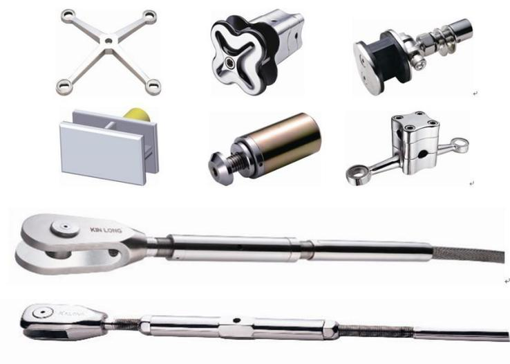
点支承玻璃幕墙构配件是实现点支承玻璃结构的通透性、艺术性和安全性的主要受力构件。其中，夹具、驳接头、驳接爪、转接件等点支承装置可有效降低玻璃受力时的附加应力和应力集中，可消除由于建筑安装带来的施工误差；拉索、拉杆、支撑杆等支承结构件主要承受玻璃面板直接传递过来的荷载。
