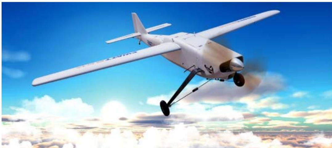
EWG-I 固定翼无人机机体结构采用新型复合材料，机身壳体和内部主要承载结构选用碳纤维和凯夫拉纤维布制作，成型产品在力学性能和外形方面较为优异；机体机构采用复合材料一体成型结构，在经受冲击及撞击时能保证机体的机构稳固，使机体主结构不易变形及弯曲；在材料实验室对无人机机体制造材料进行力学、耐腐蚀和抗拉强度等方面测试；动力装置为进口风冷航空发动机，最大马力为 12hp；航电部分包括自驾仪、数传、图传等模块，云台可搭载微单、高清摄像机、红外/紫外成像仪、夜视仪等有效载荷。
