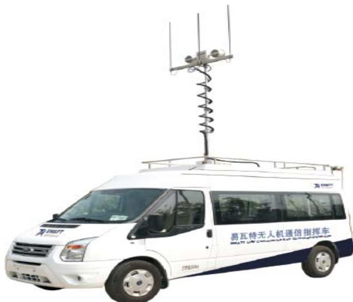
公司利用先进的大功率广播指挥系统、现代无线通信、计算机、图像采集及传输、强光照明等技术，自主研发设计的通信指挥车，可以实现指挥车与现场工作人员的通信联络、现场指挥调度等功能，通过卫星和指挥中心连接，可以实现应急现场语音、视频、数据的互联互通。主要用于现场的应急指挥，实现实时调度并实现语音通、数据通、图像通。
