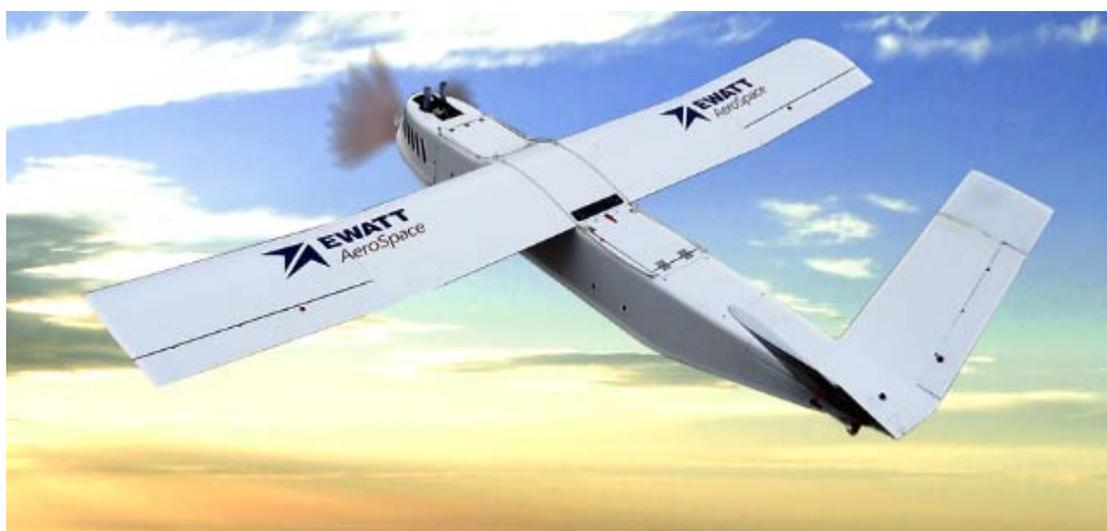
EWG-II 型无人机为公司自主研发的一款小型固定翼无人机，可为航空作业提供安全、稳定、高效的飞行平台，其低空慢速沿设定线路稳定飞行的优良特性尤胜于其他类型的飞行器。该产品可以根据需要集成各种专业任务设备，轻松胜任航空测绘、电力巡线、城市规划、石油管线巡查等作业。
