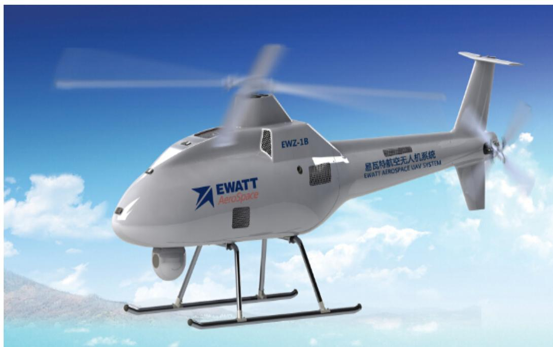
EWZ-1B 无人直升机系统主要由机体、航电系统、有效载荷、地面站、飞行保障系统及地面操作人员等六大部分组成。EWZ-1B 直升机为四旋翼气动铰接式布局，定制化的飞控系统为其提供了足够的控制稳定性和高精度；实际投运使用的主要方式为自驾操控，飞行状态有手动、半自动以及全自动三种制式可供切换。
