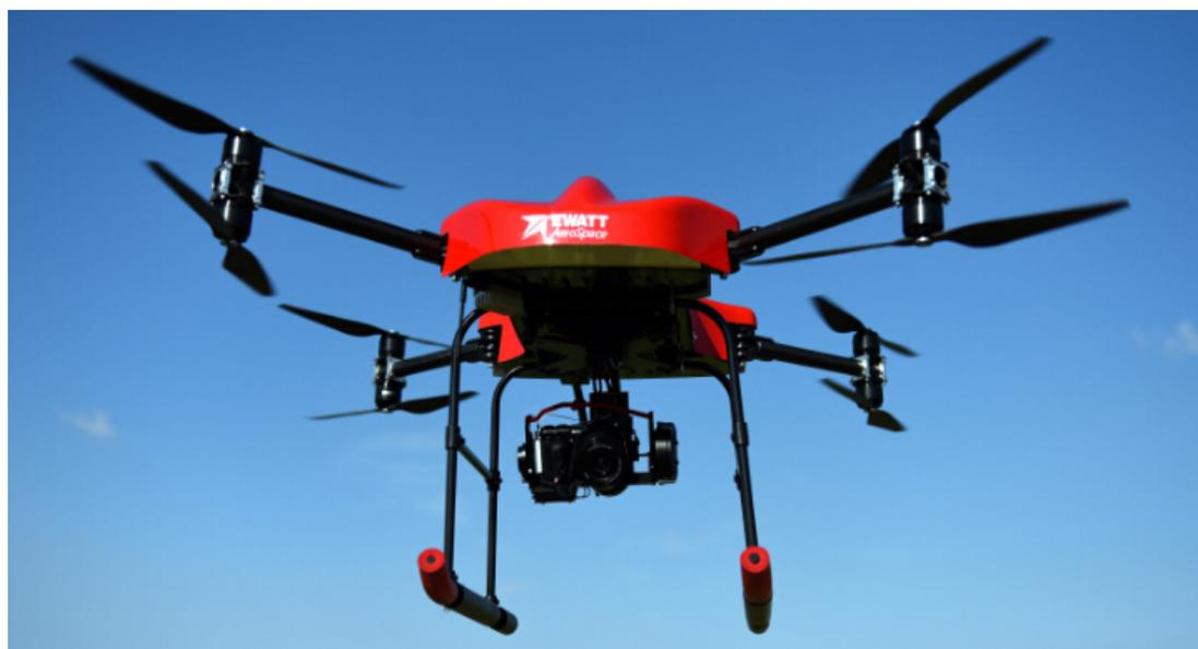
EWZ-S8mini 是公司根据性能优异的 EWZ-S8 进行改进的多用途八旋翼无人机系统，继承了 EWZ-S8 优异的飞行性能，具有体积更小、方便携带、机动灵活等特点。可用于执行资料收集、测量、检测、侦查等多种空中任务，航线控制精度高，飞行姿态平稳，控制简单可靠，可在极小的场地进行垂直起降，使用成本低。
