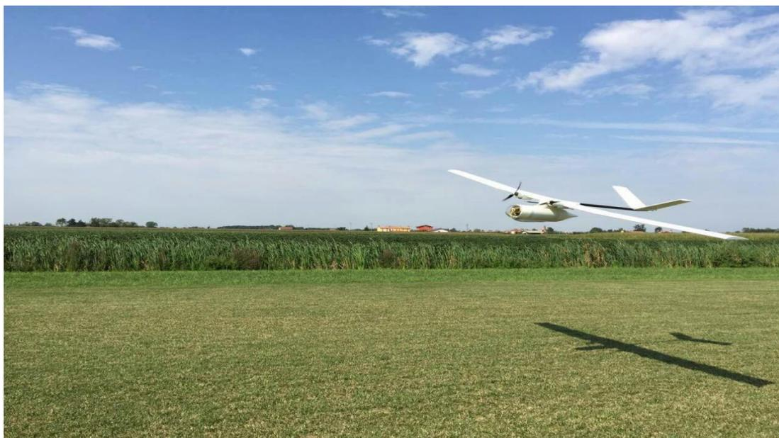
EWG-E3 固定翼无人机采用手抛/滑落或伞降起降方式，是公司自主开发的手抛双发电动固定翼无人机。设计目标是小型，高流动、便携式、高性能、多用途。该机型整体采用高效能电机，窄瘦型机身、大展弦比机翼与 V 型尾翼相结
