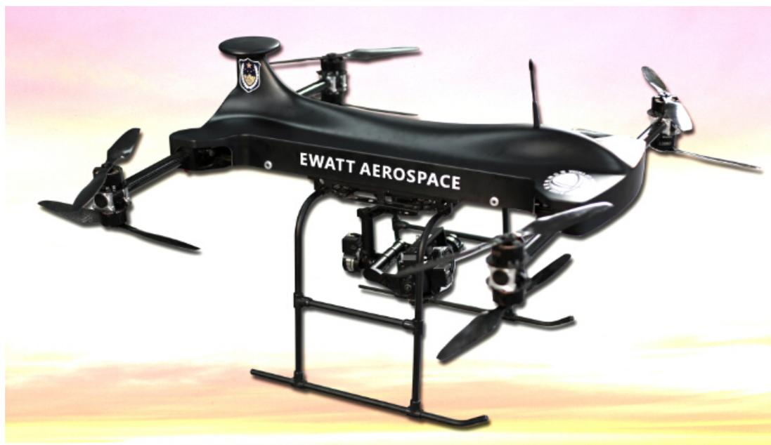
EWZ-S8 无人机机身由碳纤维板和复合材料制作而成，采用全包围型防水外壳；旋翼动力装置包括共轴双桨的八个无刷直流电机以及无刷电子调速板，动力电源采用两个大容量锂电池冗余供电；航电部分包括自驾仪、数传、图传等模块，云台可搭载微单、高清摄像机、红外/紫外成像仪等有效载荷。
